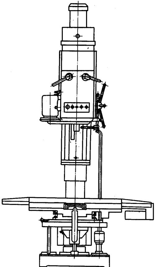
Предназначен для выполнения всех видов сверлильных работ: сверления, рассверливания, зенкерования, зенкования, развертывания, нарезания резьбы машинными метчиками, а также растачивания отверстий, получистового и чистового фрезерования.
