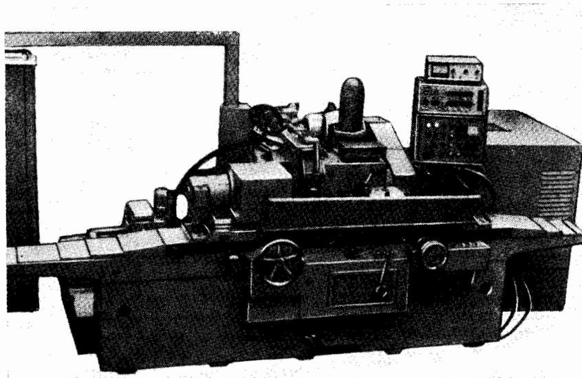
Предназначены для наружного шлифования цилиндрических и пологих конических поверхностей изделий методом врезного и продольного шлифования.
